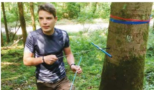
Weißtannenproben: Nick Lamprecht, Projektmitarbeiter der FVA, entnimmt Bohrkern zur Untersuchung der Jahrringbreiten.
